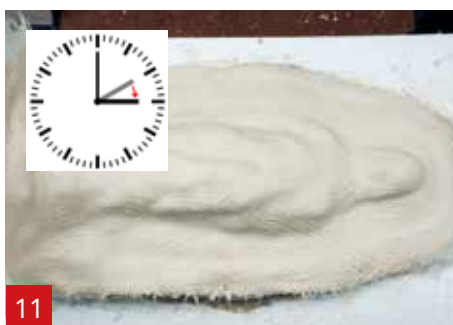
8 ... a použít 2 nd vrstva A1 Triaxiálního vlákna na ještě vlhkém A1.
