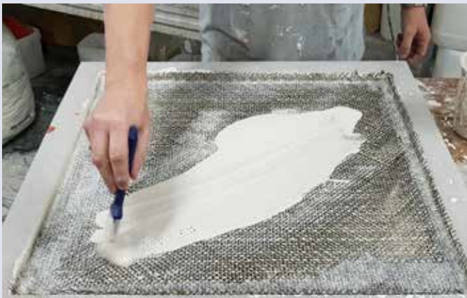
Chcete-li laminovat, musíte pracovat mokré do mokrého. Rychlý způsob aplikace A1 je štětcem nebo válečkem.
