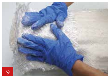
6 Přidejte triaxiální vlákno A1 na mokré A1. Pokračujte, dokud není celá silikonová forma pokryta A1 a vrstvou A1 Triaxial vlákna.
